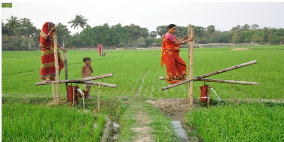
Figura 3 - KB Bamboo Treadle Pump – bomba de irrigação movida à força humana na Índia
